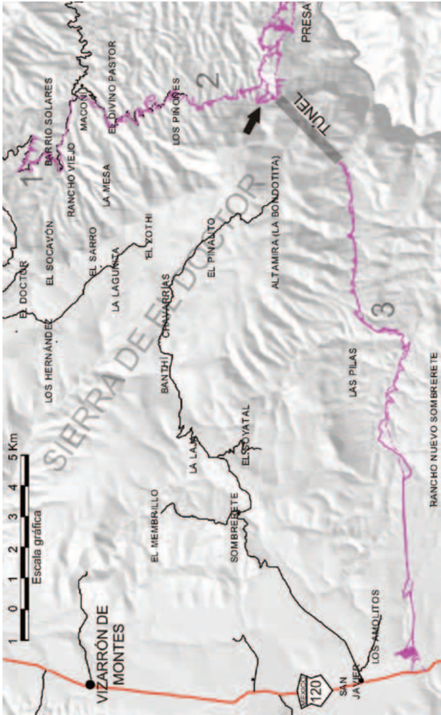
FIGURA 2. Áreas afectadas por la construcción de caminos y la instalación de tuberías para el “Acueducto II” sobre la sierra de El Doctor. Las áreas de afectación se aprecian como líneas de color rosa: Tramo 1, entre la comunidad de El Doctor y Maconí; Tramo 2, de Maconí hacia la presa de captación y el túnel; Tramo 3, del túnel a la carretera 120. La flecha negra señala el área que se muestra en la foto 6.
